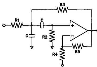
Fig. 25. VCVS bandpass filter.
